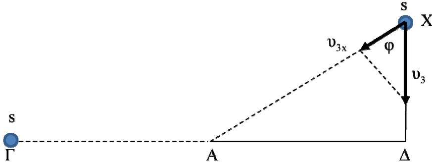
$$v_{3,x} = v_3 \cos \varphi \Rightarrow v_{3,x} = \alpha_2 \cdot t \cdot \frac{(X\Delta)}{(XA)} \Rightarrow v_{3,x} = \alpha_2 \cdot t \cdot \frac{(X\Delta)}{\sqrt{(X\Delta)^2 + (A\Delta)^2}} \quad (3)$$
