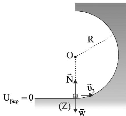
$$F_k = \frac{m_3 v_3^2}{R} \quad \& \quad N - m_3 g = \frac{m_3 v_3^2}{R} \quad \& \quad 2m_3 g - m_3 g = \frac{m_3 v_3^2}{R} \quad \& \quad v_3^2 = gR \quad \& \quad v_3 = \sqrt{gR} \quad \& \quad v_3 = 2 \text{ m/s (1)}$$
